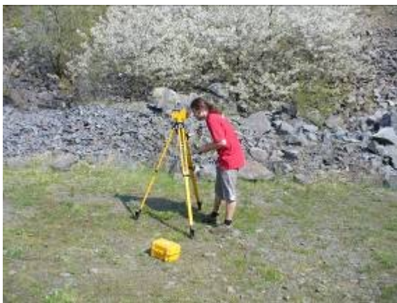
O. 2 Disciplína nivelácia – určenie výškového rozdielu
